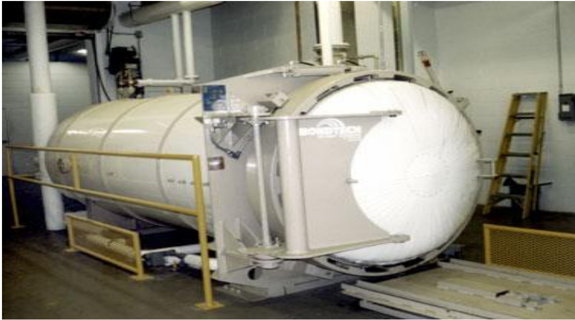
Εικόνα 22: Κλίβανος αποστείρωσης μολυσματικών αποβλήτων.
